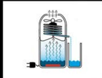
Diese Methode basiert auf dem Prinzip der Wasserverdampfung mit anschließender Kondensation. Mittels einer Kochplatte wird Wasser in einem Tank erhitzt. Der entstehende Wasserdampf wird aufgefangen und abgekühlt. Zum Abschluss wird das destillierte Wasser durch einen Aktivkohlefilter geleitet.
