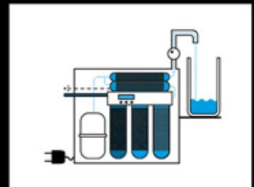
Sie ist die technische Umkehrung des in der Natur vorkommenden Osmose-Prinzips. Dabei wird das Leitungswasser durch eine halbdurchlässige, extrem feinmaschige Membran (RO-Membran) gepresst, wobei nur die Wassermoleküle diese passieren können. Sämtliche Schad- und Giftstoffe, aber auch Mikroorganismen wie Bakterien und Viren können aufgrund ihrer molekularen Größe die Membran nicht durchdringen.
