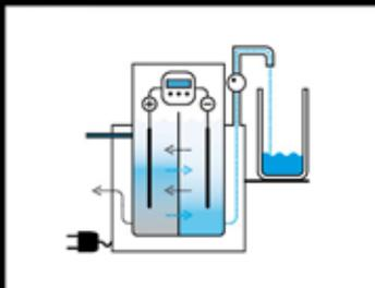
Dieses Verfahren basiert auf dem Prinzip der Elektrolyse. Dabei werden die Ionen im Leitungswasser mittels Strom verschoben, um beispielsweise eine sehr hohe Mineralienkonzentration, einen sehr hohen pH-Wert, einen extrem niedrigen Redoxwert oder eine sehr hohe Wasserstoffkonzentration im Ausgangswasser zu erreichen. In Japan und Korea wird ionisiertes Wasser – auch antioxidatives, basisches oder Aktivwasser genannt – teilweise zu Therapiezwecken genutzt.
