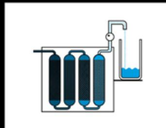
Für dieses anerkannte physikalische Verfahren werden Hohlfasern mit teildurchlässigen Strukturen hergestellt, sodass deren Wände als Membran wirken. Im Handel werden diese Membranen in Verbindung mit Sedimentfiltern und Aktivkohlefiltern als Ultrafiltrationsanlagen für Privathaushalte angeboten.
