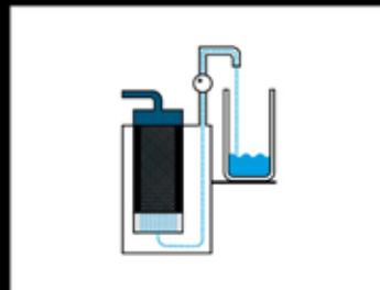
Es gibt GAC (= Granular Activated Carbon) Filter mit Aktivkohlegranulat und hochwertigere Aktivkohleblockfilter (CTO = Chlorine, Taste, Odor).
