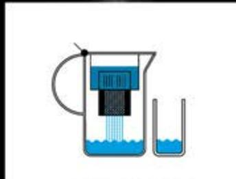
Dies sind auf Ionenaustauschern bzw. Aktivkohle basierende, sogenannte offene Filtersysteme, die ähnlich einem Getränkekrug mit Leitungswasser gefüllt werden und beim Ausgießen gefiltertes Wasser abgeben. Meist werden nur Kalk und Chlor herausgefiltert.
